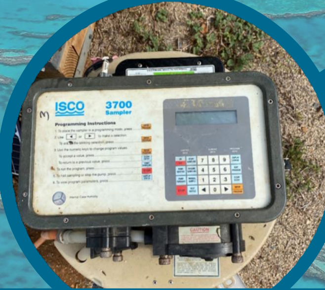
Effluent Sampler: ISCO 3700
